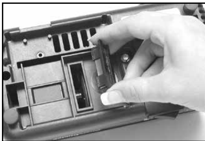
Малюнок 18. Зняття кришки нижньої панелі для очищення від металевого пилу (див. розділ Повсякденне обслуговування).
