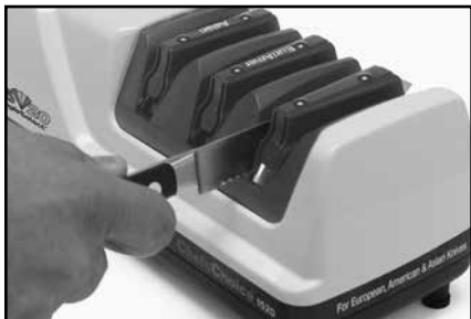
Рис. 14. Для заточки зубчатых ножей используйте только Устройство 3.
