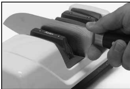
Малюнок 17. Поставте вказівний палець, як показано, позаду незаточеної ділянки, коли ніж вставляється в паз для заточування (див. Рекомендацію 8).
