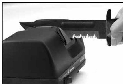
Рисунок 9. Заточка зубчатых лезвий в Этапе 2. Показано лезвие с заусенцами с левой стороны лезвия. (Смотрите инструкцию).
